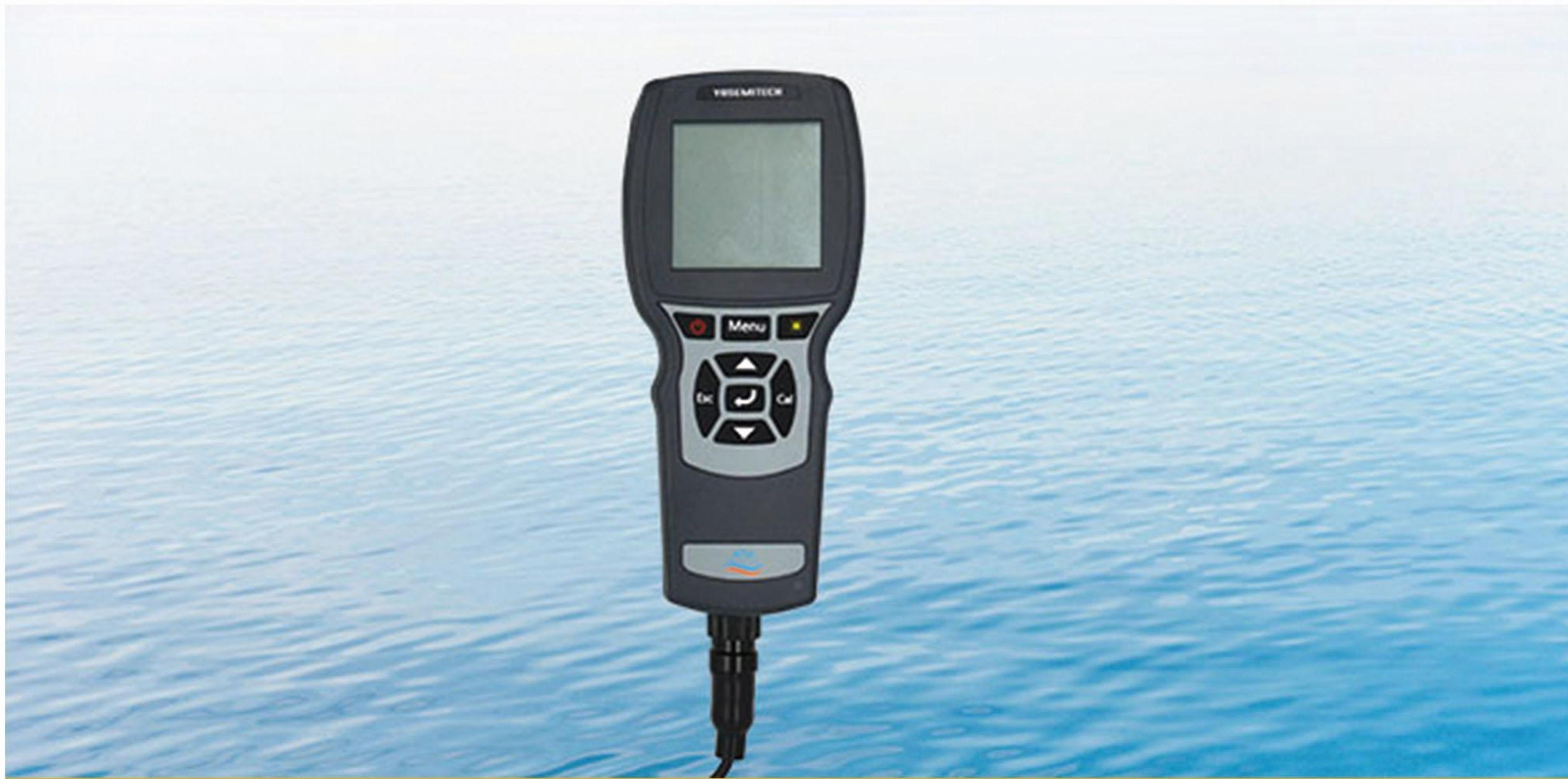
禹山Y600-A由禹山传感自主研发。本仪表带背光显示和操作键盘，功能全面操作简单，界面简洁，支持禹山传感各型号传感器的自动识别（光学溶解氧/四电极电导率/光学浊度/叶绿素/pH/ORP/ BGA /水中油/污泥浓度/COD/氨氮/CDOM等）、数据读取、存储、传感器校准等功能，并支持USB数据导出，实现更多高端功能。追求高性价比是我们一贯的追求。
